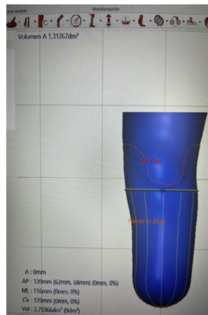
Figura 1. Cálculo de volumen del muñón mediante el programa CAD/CAM.
